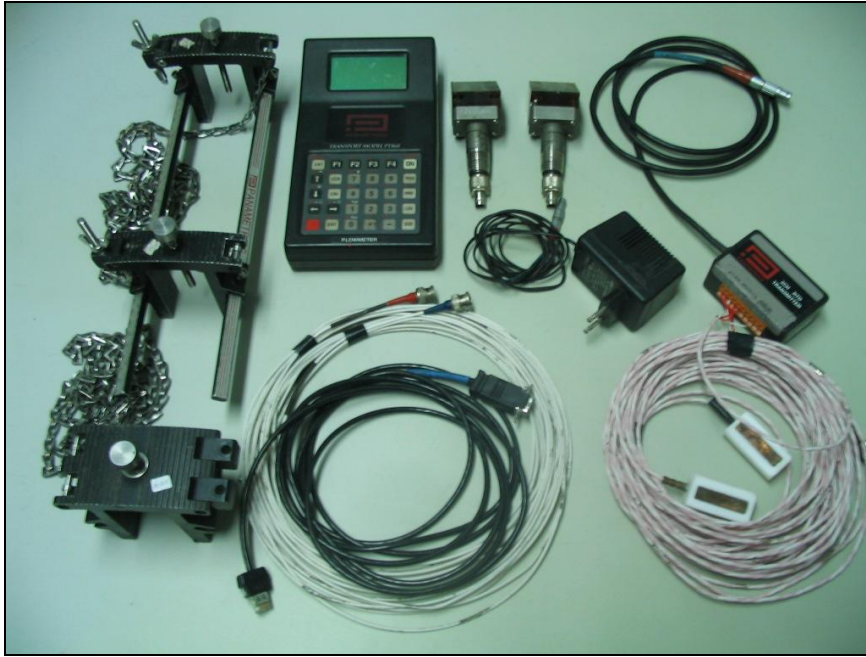
เครื่องมือวัดอัตราการไหลน้ำเย็น แบบอัลตราโซนิก (Ultrasonic Flow Meter)
