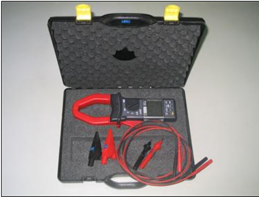
เครื่องมือวัดกำลังไฟฟ้า แบบชั่วคราว (Power Meter)
